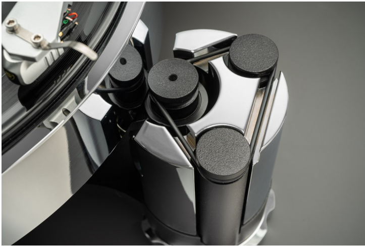
Gegen seitliche Bewegungen wirkt jeweils ein Gummiring - so wird das Subchassis in Position gehalten.
