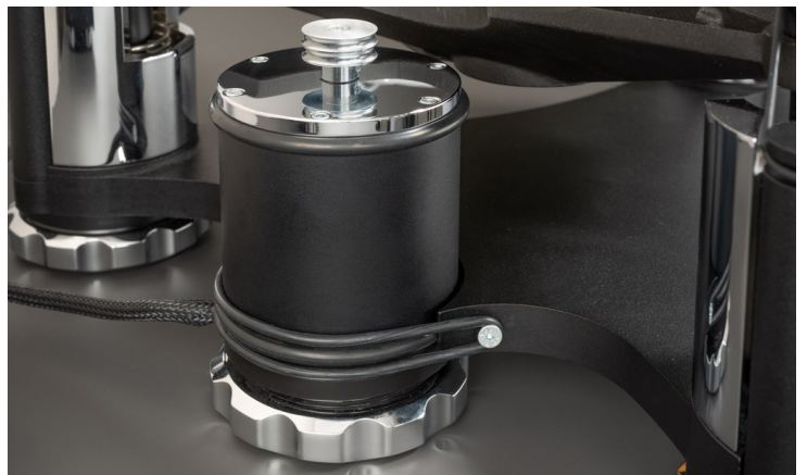
Der kräftige Antrieb ist in einer separaten Motordose untergebracht, sie schmiegt sich in die Aussparung des Chassis. Dazwischen sitzt ein Gummiring für die Vibrationspufferung, der andere Ring presst den Motor an die Basis. Damit alles perfekt passt, ist auch die Motordose höhenverstellbar.
